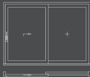
2-teiliges Element mit Hebe-Schiebeflügel und Festverglasung
