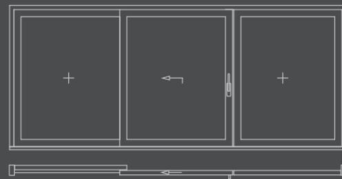
3-teiliges Element mit Hebe-Schiebeflügel und zwei Festverglasungen
