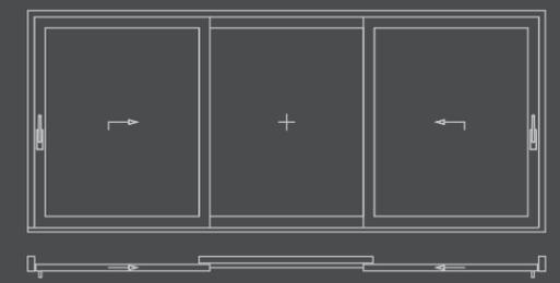
3-teiliges Element mit zwei Hebe-Schiebeflügeln und Festverglasung
